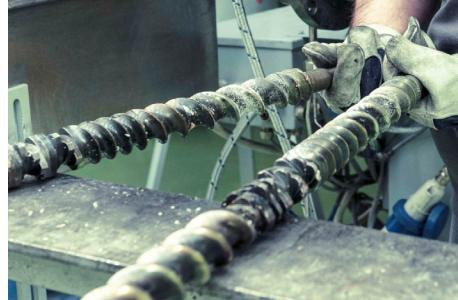
Clean Xpress permite limpiar el husillo y el cilindro de la extrusora y/o la inyectora en muy poco tiempo y sin parar la producción
